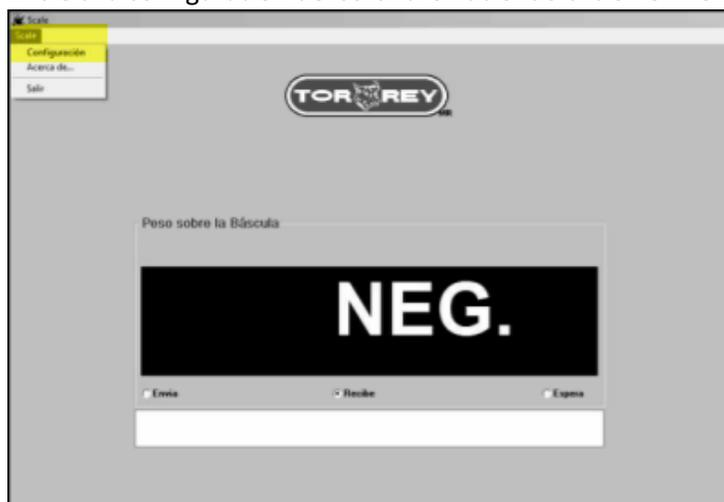
4. Dentro de la configuración, seleccione el puerto donde está conectada la báscula y deje los otros valores exactamente como se observa en la imagen. OJO: ponga atención a la configuración "Enviar a Archivo", pues si la deja deshabilitada el sistema no podrá leer el peso enviado por la báscula.
